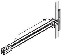
Faites glisser l'anneau en plastique le long des attaches jusqu'à ce que le rebord de l'anneau soit parfaitement appuyé contre le mur.
